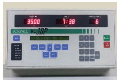
Fig.8: Especificaciones de la Centrifuga Refrigerada (3500rpm a 6°C).
