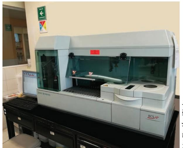
Fig.2: Coagulómetro Computarizado Automatizado
