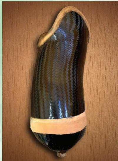
Fig.6: socket de fibra de carbono terminado
