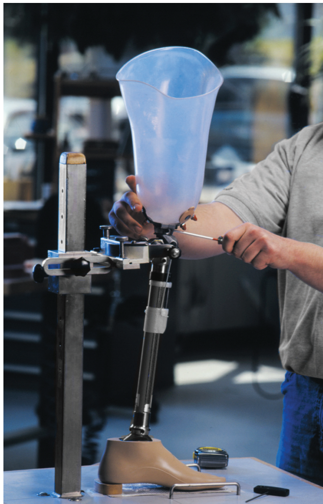
El socket es la interfaz entre la extremidad residual del paciente y la prótesis. Sin un buen socket, incluso la mejor de las prótesis será incómoda y difícil de usar.
